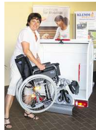
Der Rolli-Sherpa, eine Entwicklung der Firma Klemm, zum Transport mechanischer Rollstühle. Durch die Montage auf der Anhängerkupplung bleibt der Innenraum für die Passagiere frei.
